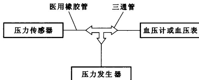
图 1 检定设备连接示意图
